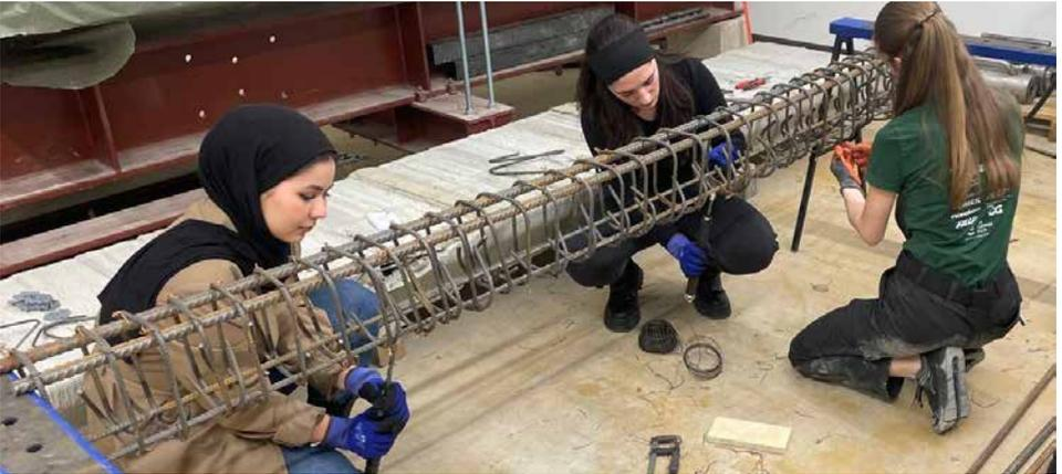
Darauf aufbauend bietet das Baupraktische Labor an der Hochschule Campus Wien echte Hands-on-Erfahrung. Studierende können je nach Interesse Schwerpunkte in Sanierung von Hochbauvorhaben, Betonbau oder Holzbau wählen. Hier wird praktisch gearbeitet: Bauteile werden vor Ort untersucht, Betonträger gegossen und getestet oder eigene Holzbauprojekte umgesetzt. So wird das theoretische Wissen unmittelbar mit der Praxis verknüpft – ein direkter Einblick in die Arbeit von Bauingenieur\*innen.
